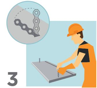
Levantar los anclajes de acero galvanizado que están en la parte posterior de la pieza.
